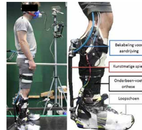
Figuur 1. A) Onderzoekopstelling met proefpersoon in rust op de loopband. B) Schematisch overzicht van het exoskelet.
